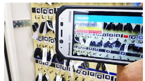
①拠点に車両が入庫した時に、車両番号バーコードが付いた鍵とARマーカ―付きキーホルダ―を連結すると共にAndroidスマートフォン（以下スマホ）でバーコードとARマーカ―を読み、データを紐付けし、サーバに登録。
